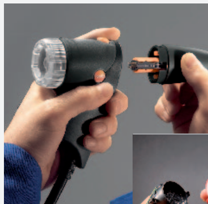
Remplacement de la canne
