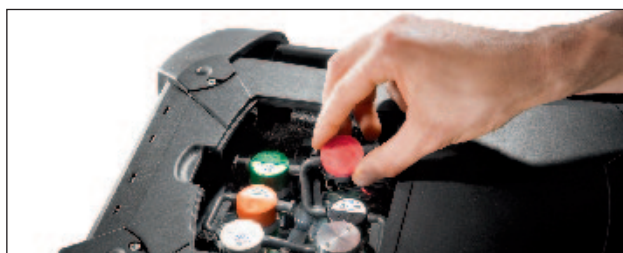
Remplacement aisé des cellules comme de simples piles
