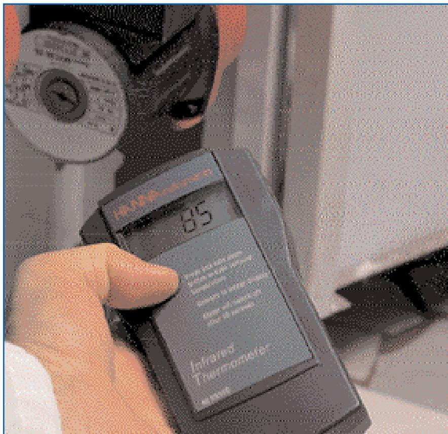
Les radiations infrarouges émises par un objet dépendent de sa température. Le thermomètre à infrarouge HI 99550 de HANNA instruments® utilise cette technologie pour mesurer la température de surface. Les mesures infrarouges sont extrêmement pratiques, et la réponse est instantanée. Autre avantage notable, les mesures ne sont pas intrusives. Cette caractéristique peut générer des économies substantielles pour les industries où les produits sont scellés ou pré-emballés.
